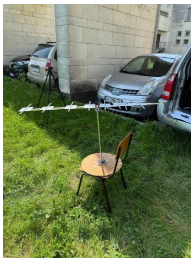
Рисунок 3.7 – Антена Ягі-Уда закріплена на саморобному кріпленні.
