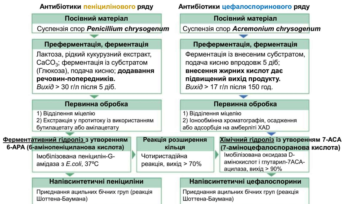
Рис. 2.26. Схема промислового отримання \beta -лактамних антибіотиків шляхом мікробного синтезу. Пояснення в тексті. Адаптовано з [77]
