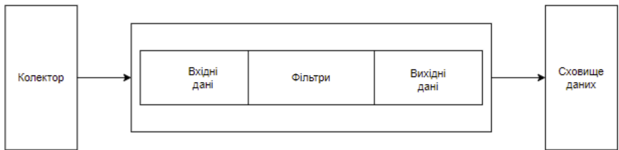
Рис. 6. Загальний алгоритм роботи Logstash
