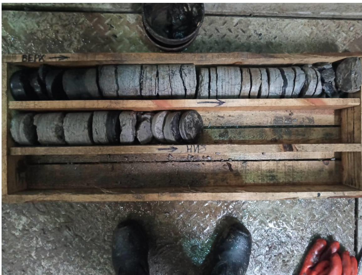
Рис. 3.3.1 Зразок укладання керна в ящик, перед описом (св-на №61).
