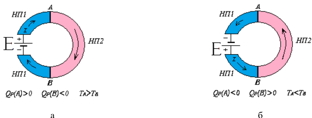
Рис.1.1. Замкнутий ланцюг, що складається з двох різних за типом провідності напівпровідників: а) виділення тепла (контакт А). б) поглинання тепла (контакт В). [1-4]
