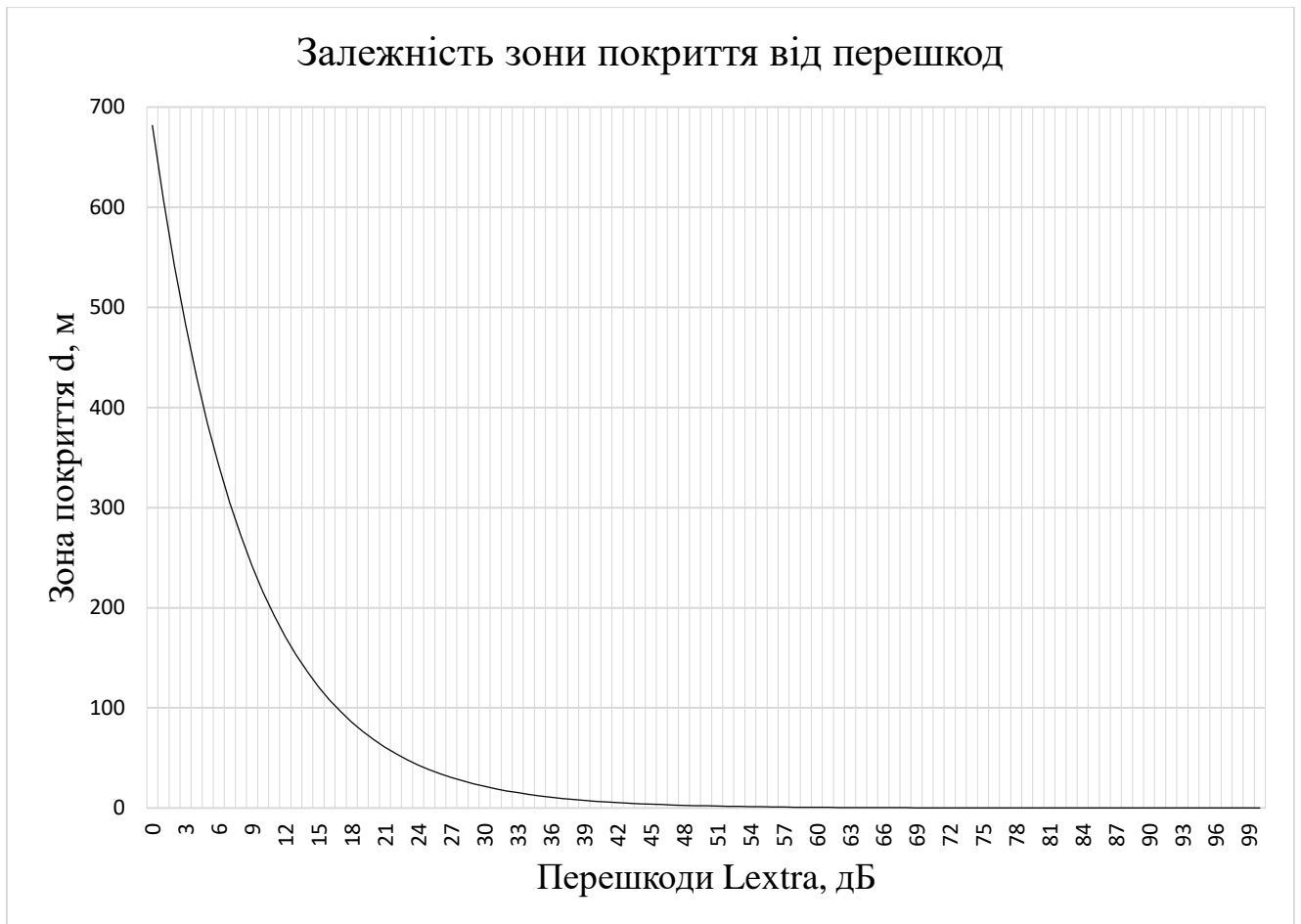
Рисунок 5.1 – Графік залежності відстані зони покриття від перешкод
