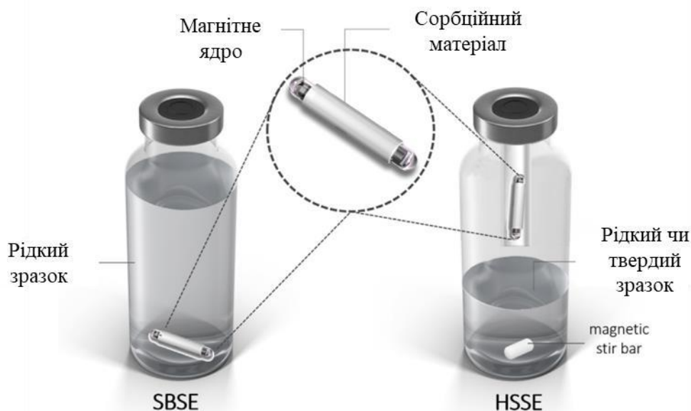
Рис.1.4. Вигляд комерційного якірця з покриттям фірми Герстел для проведення сорбційної екстракції на якір магнітної мішалки з розчину чи з газової фази (адаптовано з [11]).
