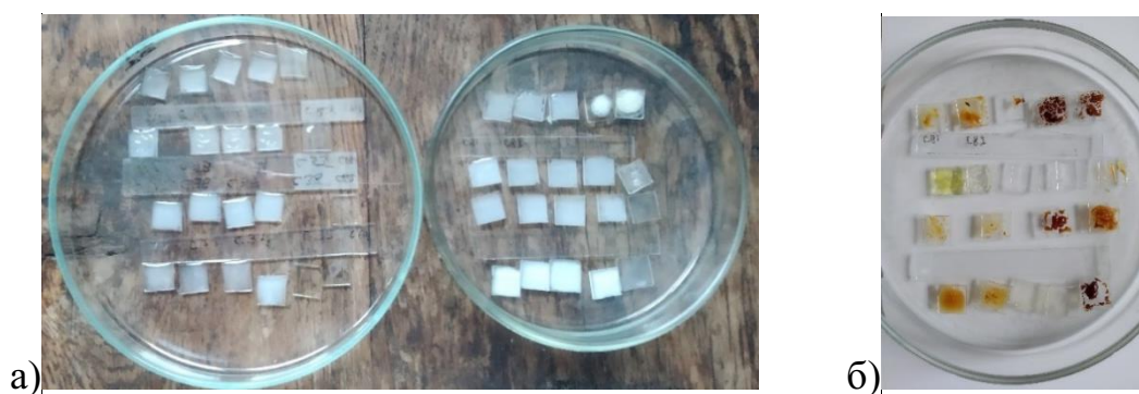
Рис.4.2. Приклади покриттів а) з вмістом титану, б) з нітрогенвмісними прекурсорами (які за присутності більше 15% потемніли при висушуванні).
