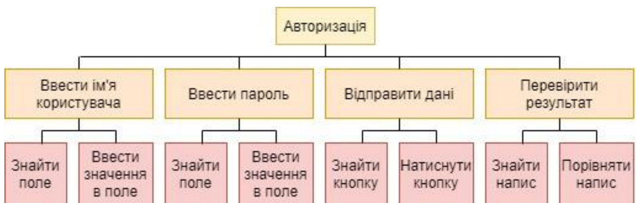
Рисунок 2 – Приклад функціональної декомпозиції
