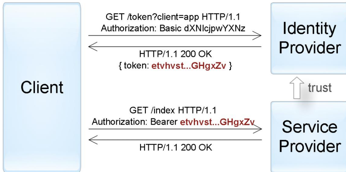
Рисунок 1.1 Схема аутентифікації клієнта за допомогою токена, переданого за допомогою Bearer схеми.
