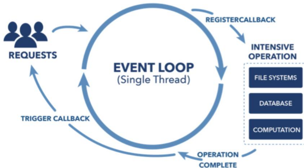
Рисунок 5.3 – Архітектура обробки подій всередині V8
