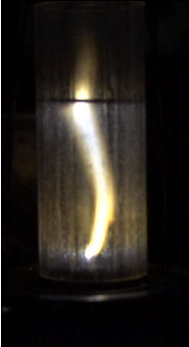
Рис.1.2.7 Фото з експерименту оптичного дослідження плазми , який підтримується обертовим ковзним розрядом
