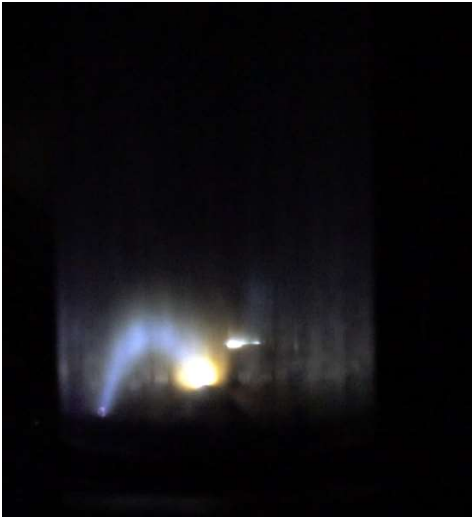
Рис.1.2.6 Фото з експерименту, де наглядно можна побачити обертово-ковзний розряд.
