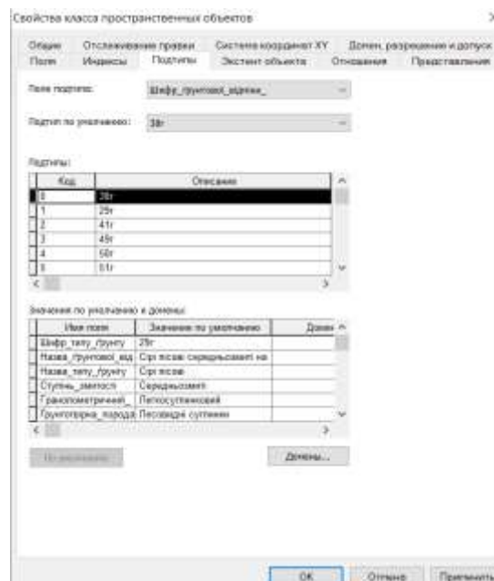
Рис. 2.1.2. Приклад створення підтипів та встановлення значень за замовчуванням полів класу просторових об'єктів Ґрунти .
