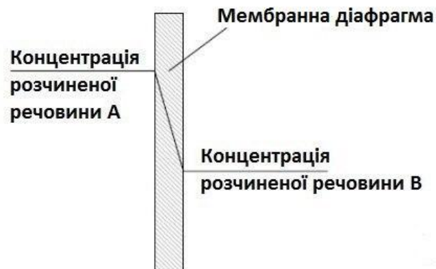
Рис 1.6 Типовий вигляд профілю розчиненої речовини у дифузійній камері
