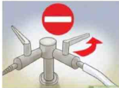
Рис 1.3. Положення крана газозабезпечення у перекритому стані
