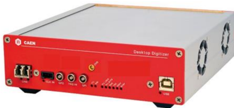
Рис. 2.1. Зовнішній вигляд цифровайзера CAEN DT5761. Прилад виконаний у настільному корпусі червоного кольору, що є характерною ознакою лінійки CAEN Desktop Digitizers. На передній панелі розташовані оптичний роз'єм LINK, роз'єми синхронізаційних сигналів CLK IN, GPO, TRG IN, GPI, лінійка світлодіодів стану (PWR, USB, TRG, BUSY) і USB-роз'єм для зв'язку з комп'ютером та аналоговий вхід каналу CH0.
