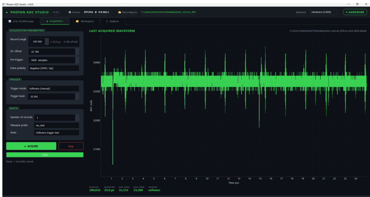
Рис. 4.4. Запис, виконаний у режимі програмного тригера на платі DT5761 з підключенням SiPM. Параметри запису: довжина 100 016 відліків, тривалість 25 мкс при частоті 4 GS/s, зміщення нуля 32768, передісторія 5000 відліків. У правій частині інтерфейсу відображається повна осцилограма запису — на тлі базової лінії з шумом видно регулярну послідовність негативних імпульсів різної амплітуди. Внизу під осцилограмою — числові підсумки: 100 016 відліків, тривалість 25.0 мкс, мінімальне і максимальне значення 31232 і 33280 кодів АЦП, тип тригера software. Файл збережено як sw_test_0003.phadc .
