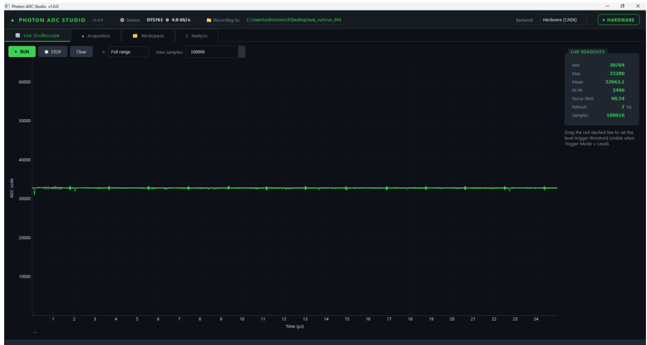
Рис. 4.3.. Осцилограма у режимі вільного запуску ( Live Oscilloscope ), отримана з реальної плати DT5761 з підключеним модулем SiPM. У режимі Auto-fit вертикальної шкали добре видно структуру сигналу: базова лінія на рівні близько 32660 кодів АЦП, гаусівський шум з RMS близько 100 кодів, поодинокі негативні імпульси різної амплітуди — справжні фотонні події. Загальна кількість зчитаних відліків за час перегляду — близько 100 тисяч, частота оновлення кадрів — близько 7 Гц через відносно велике вікно перегляду (також 100 тисяч відліків). На правій панелі індикаторів виведено фактичні оцінки сигналу: min 30784, max 33280, mean 32662.1, peak-to-peak 2496, noise RMS 98.54.
