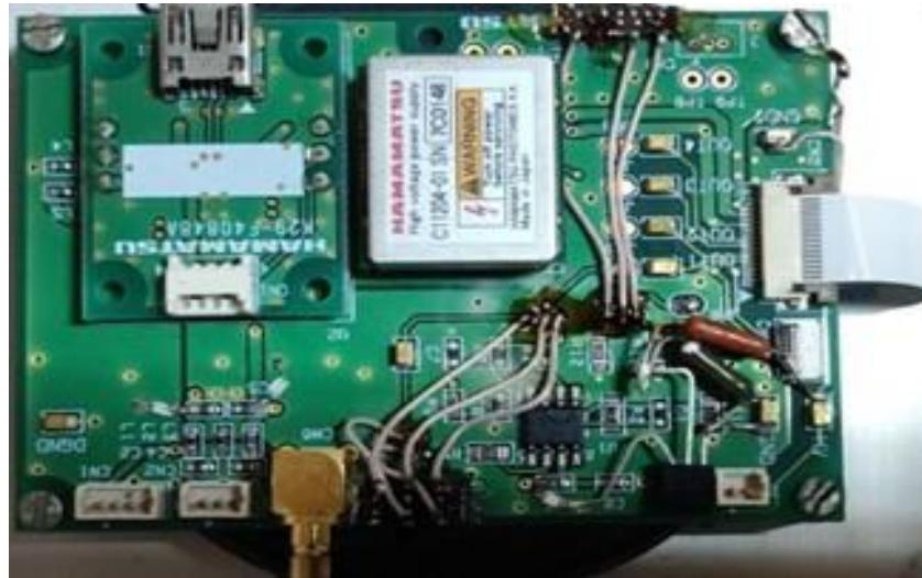
Рис. 2.2. Детекторний модуль на основі кремнієвого фотопомножувача. На спільній друкованій платі змонтовані сам SiPM-сенсор Hamamatsu MPPC (зелений квадратний модуль ліворуч на платі, з білим прямокутником по центру), програмно-кероване джерело високовольтного живлення Hamamatsu C11204-01 (сірий блок зверху по центру), розв'язувальні та узгоджувальні елементи аналогового тракту. Внизу плати розташовано SMA-роз'єм для виходу сигналу до цифровайзера.
