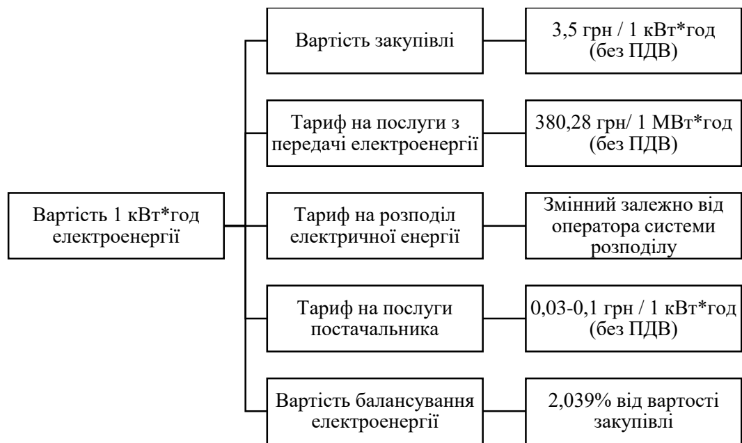
Рис. 2.1. Складові ціноутворення на торгівлю електроенергією*
