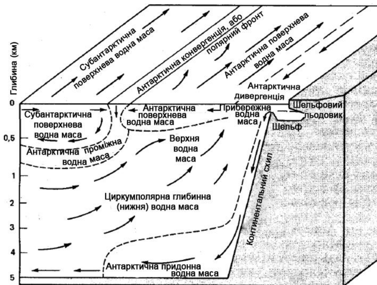
Рис. 2.3.5. Блок-діаграма структури антарктичних вод, що залежить від широтно-кліматичної зональності [7]
