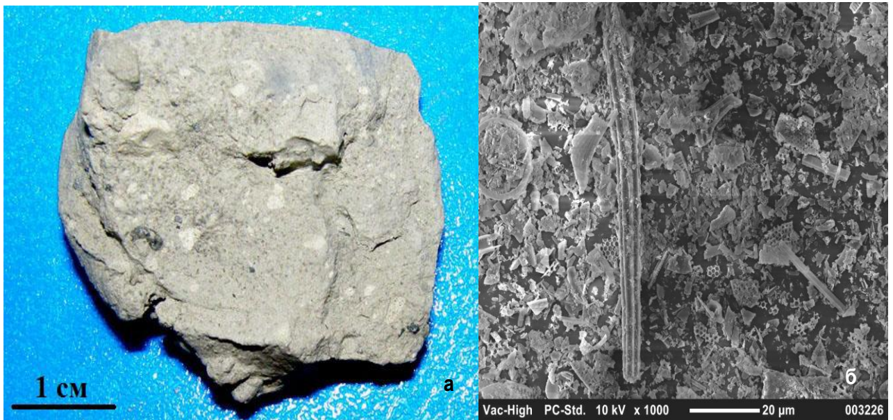
Рис. 3.3.2. Зразок верхньочетвертинного алевриту з інтервалу 0,38-0,50 м колонки: а – алеврит з включенням шматочків діатоміту; б – знімок діатоміту під мікроскопом (СЭМ)
