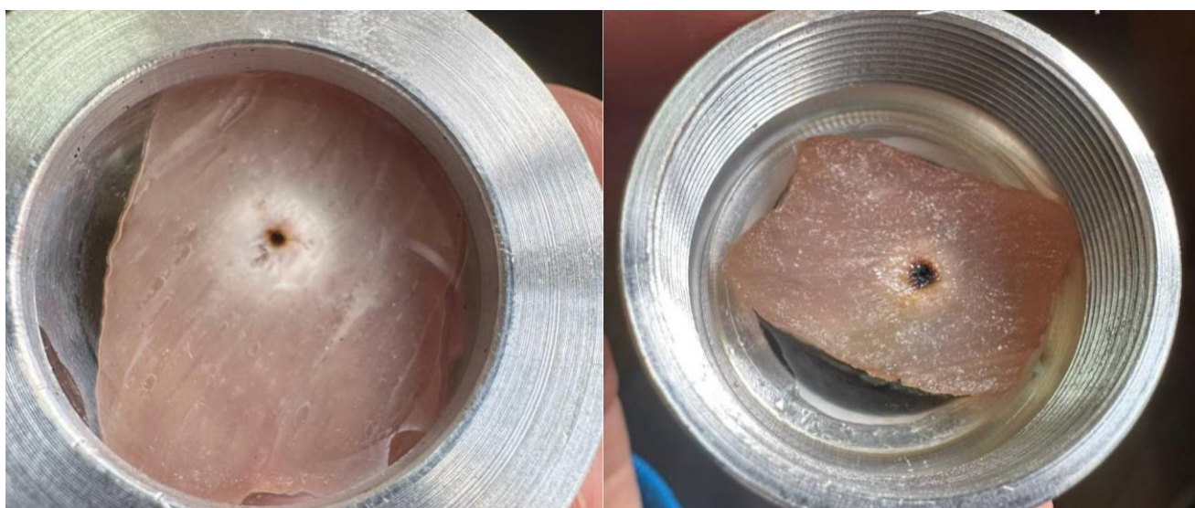
Рис. 3.7. Зразок з обох сторін після впливу лазерного випромінювання з лінзою 5 см
