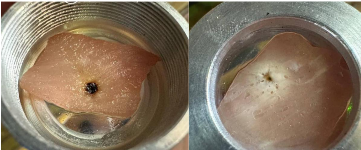
Рис. 3.10. Зразок з обох сторін після впливу лазерного випромінювання з лінзою 10 см
