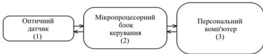
Рис. 1.1. Структурна схема апаратно-програмного комплексу для контролю змін периферійного кровотоку та динаміки трансформації молекул оксигемоглобіну [10].
