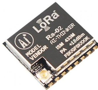
Рис.2.1 Модуль sx1278 (Ra-02) [17]
