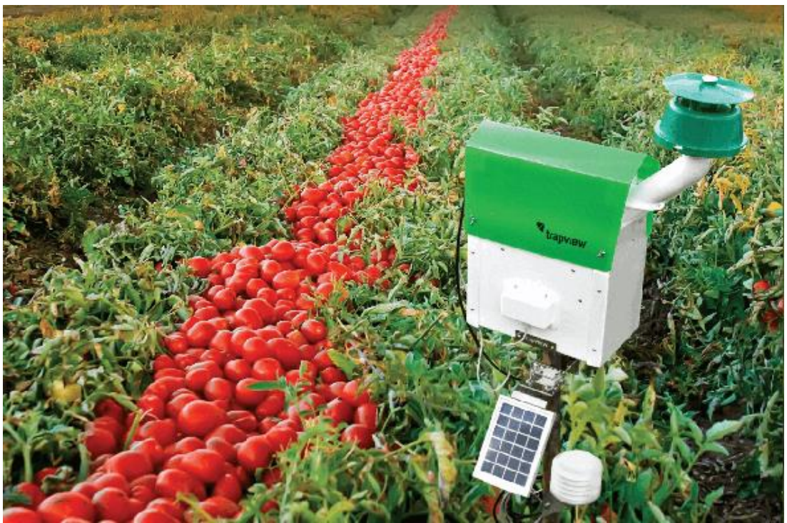
Рисунок 1.6 – Пристрій моніторингу комах-шкідників у теплиці [15]
