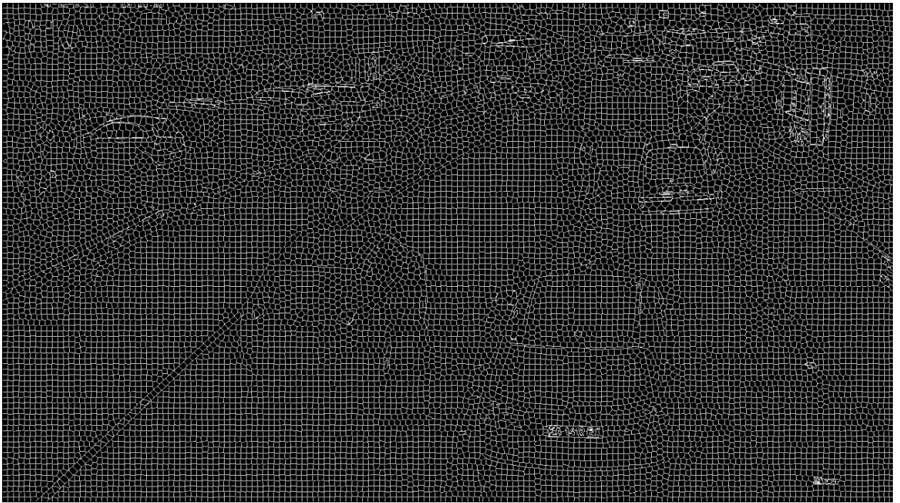
Рис. 6 Маска контурів функції SuperpixelSLIC з середнім розміром суперпікселя 10 пікселів із застосуванням алгоритму SLIC.
