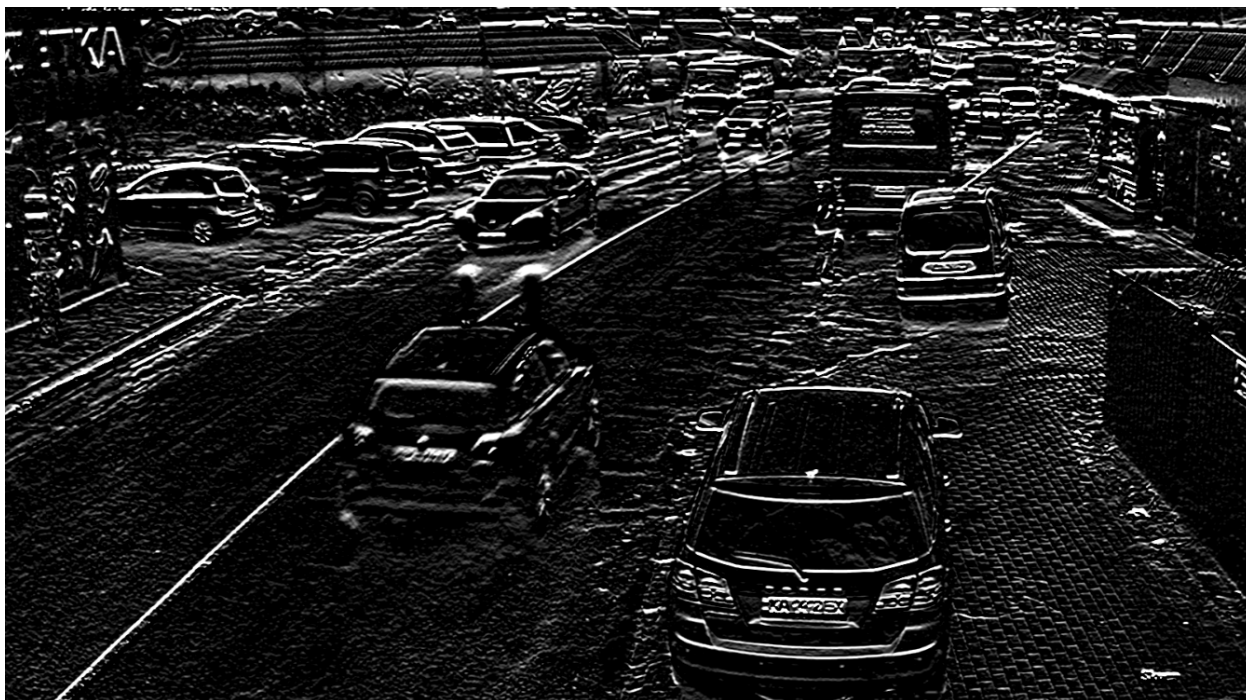
Рис. 10, Вертикальний оператор Собеля
