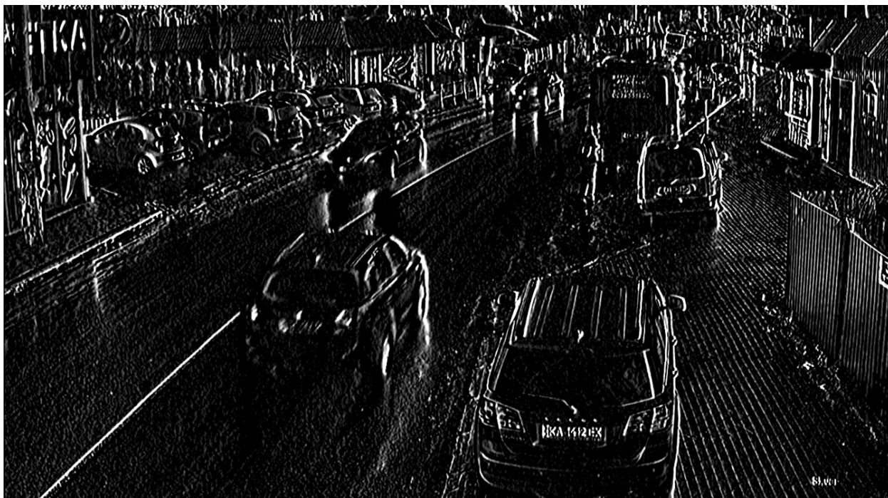
Рис. 9, Горизонтальний оператор Собеля
