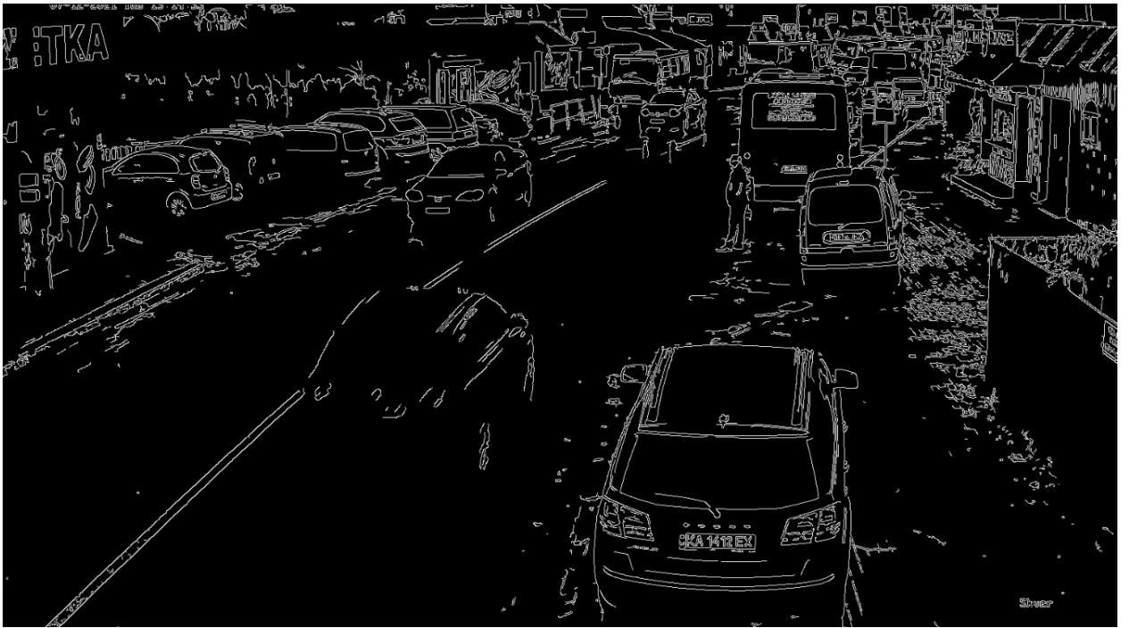
Рис. 13, визначення граней за методом Канні.
