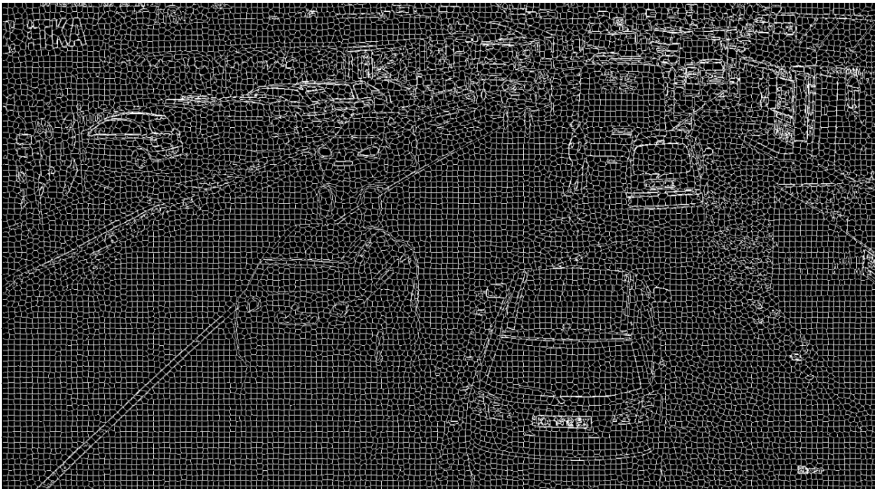
Рис. 3 Маска контурів алгоритму SuperpixelLSC з середнім розміром суперпікселя 10 пікселів.
