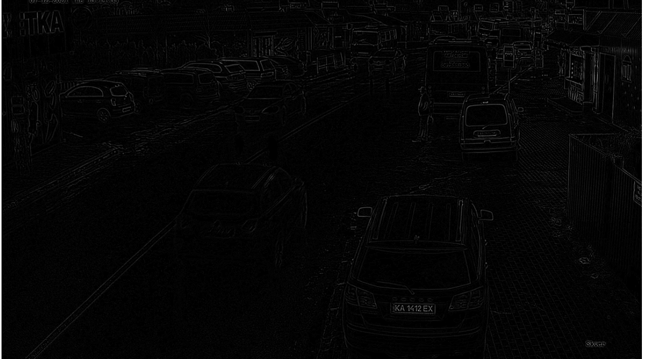
Рис. 12, Застосування оператора Лапласа до зображення з розмиттям за Гаусом.
