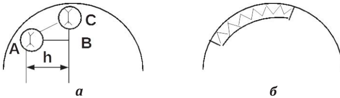
Рисунок 3.18 – Розташування ланцюга в порі: а – вздовж осі циліндра; б – в площині, перпендикулярній осі циліндра
