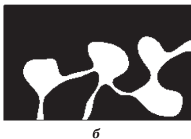
Рисунок 3.16 – Схема розташування порожнин в твердій матриці: a – система \text{PSi}/\text{C}_{18}\text{H}_{36} , б – система \text{KSK 2.5 -OH}/\text{C}_{18}\text{H}_{36}
