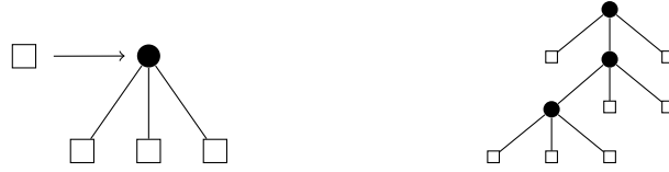
Рис. 1.1: Правило побудови D -арного дерева при D = 3 та приклад його реалізації на момент часу n = 3 .
