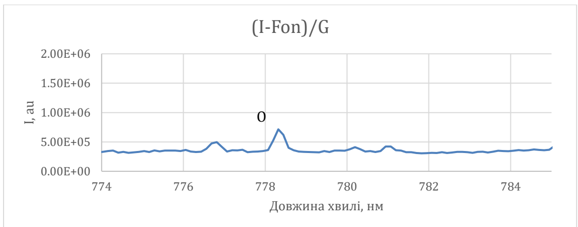
Рис 4.10 - Експериментальний спектр випромінювання кисню в околі 777 нм
