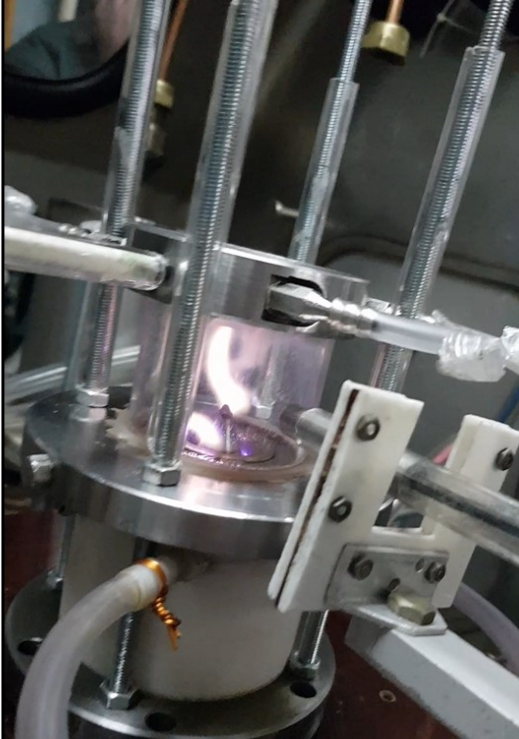
Рис 3.4 - Фотографія системи з вторинним розрядом, що підтримується обертним ковзним розрядом
