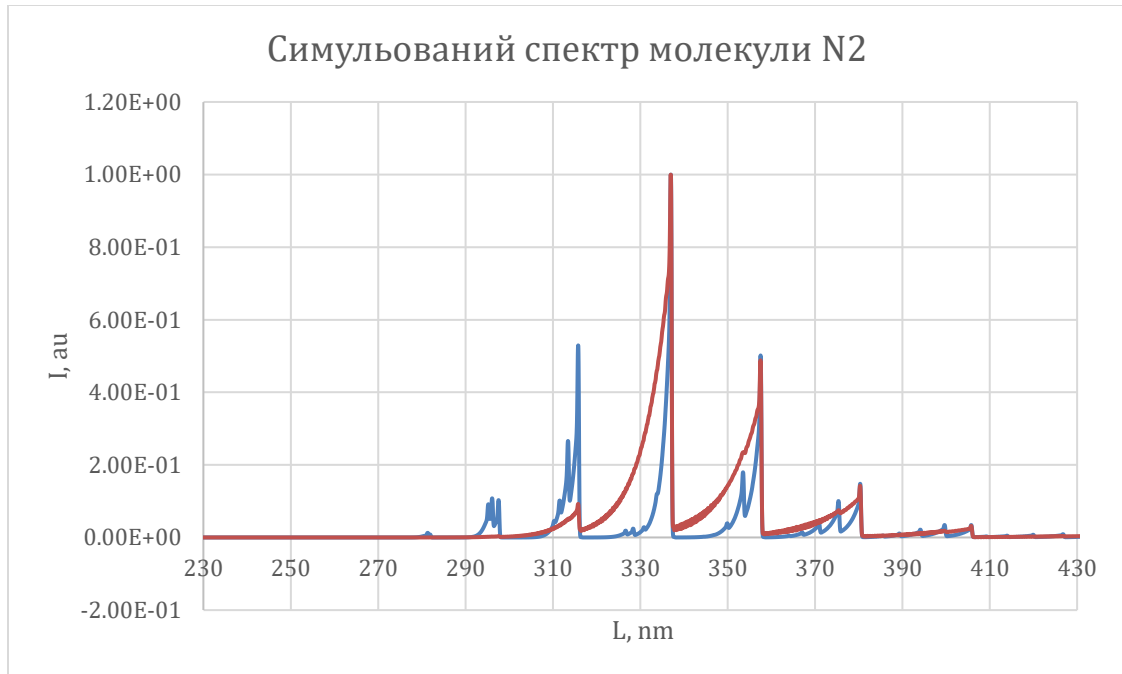
Рис. 2.4 - типовий спектр випромінювання для молекули N2 симульований в SPECAIR за різних T_r^*
