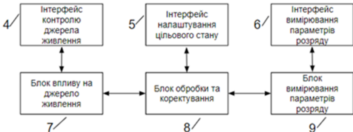
Рис. 3.13 - Структурна схема підсистеми утримання цільового стану розряду.
