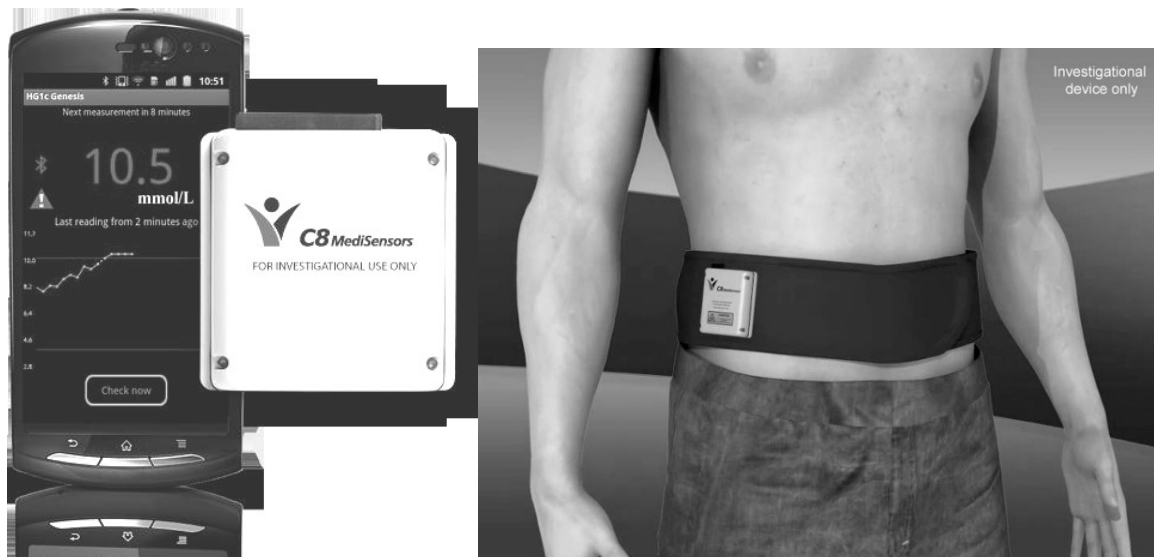
Рис. 1.5. Глюкометр на базі спектроскопії КР та його вигляд на тілі людини [4].
