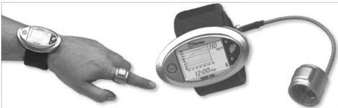
Рис. 1.7. Неінвазійний глюкометр OrSense NBM-200G [8].
