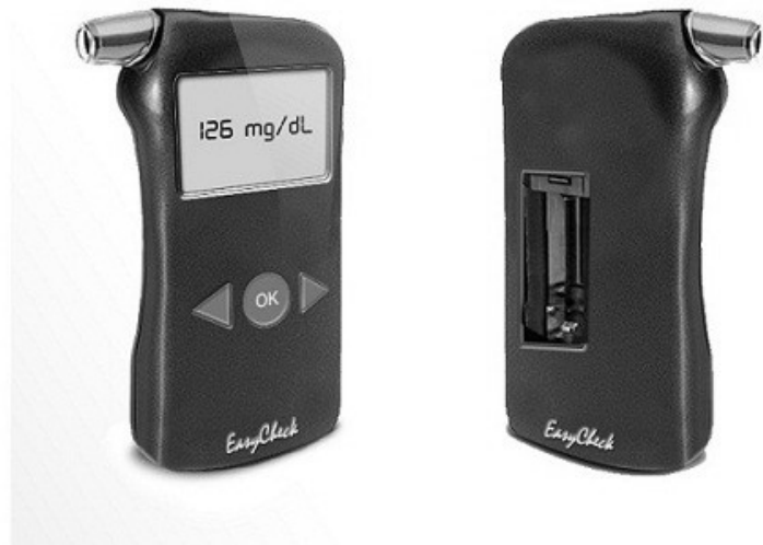
Рис. 1.6. Глюкометр Easy Check™ на базі хімічного аналізу ацетону у видиху[15].
