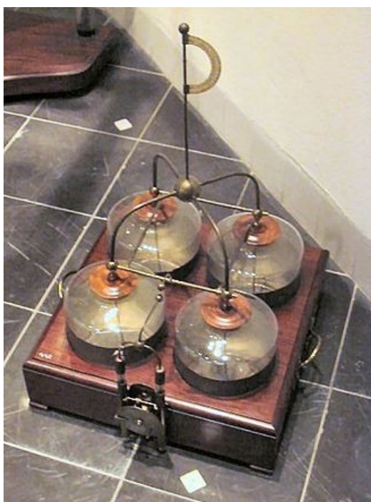
Рис 1.2 Батарея, що складається із з'єднаних скляних конденсаторів
