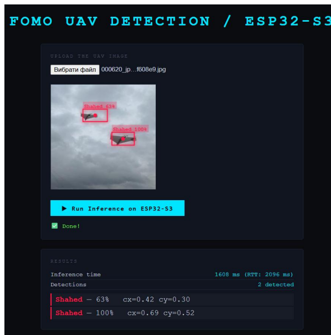
Рисунок 4.3 – Розпізнавання декількох БПЛА Shahed за допомогою моделі 4 на ESP32-S3
