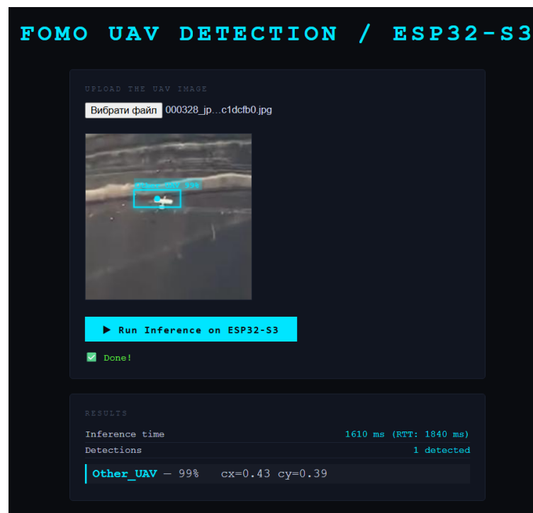
Рисунок 4.5 – Розпізнавання невеликого зображення БПЛА Other_UAV за допомогою моделі 4 на ESP32-S3
