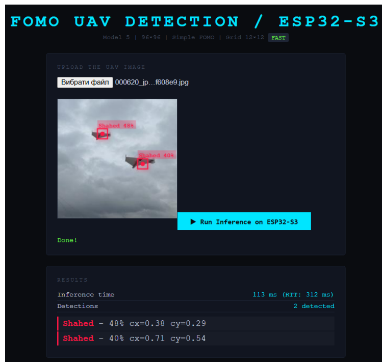
Рисунок 4.6 – Розпізнавання декількох БПЛА Shahed за допомогою моделі 5 на ESP32-S3
