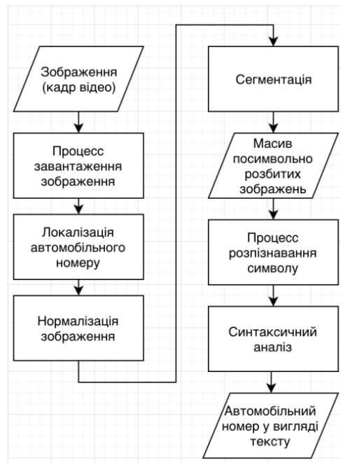
Рисунок 1.2 Алгоритм роботи системи розпізнавання автомобільного номеру
