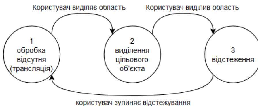
Рис. 2.1. Діаграма станів для модуля обробки зображень
