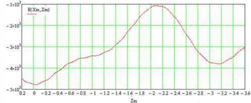
Переріз 3D графіка повної магнітної енергії (зроблений посередині по вертикалі, тобто при Xm=0 )
