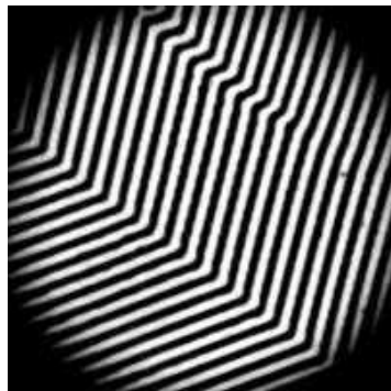
Рис. 3.3 Смугаста структура доменів ЗІГ, орієнтованих вздовж двох легких осей (проекцій осей \langle 111 \rangle легкого намагнічування кубічного кристала на площину (111)). Період доменної структури P=10 мкм.
