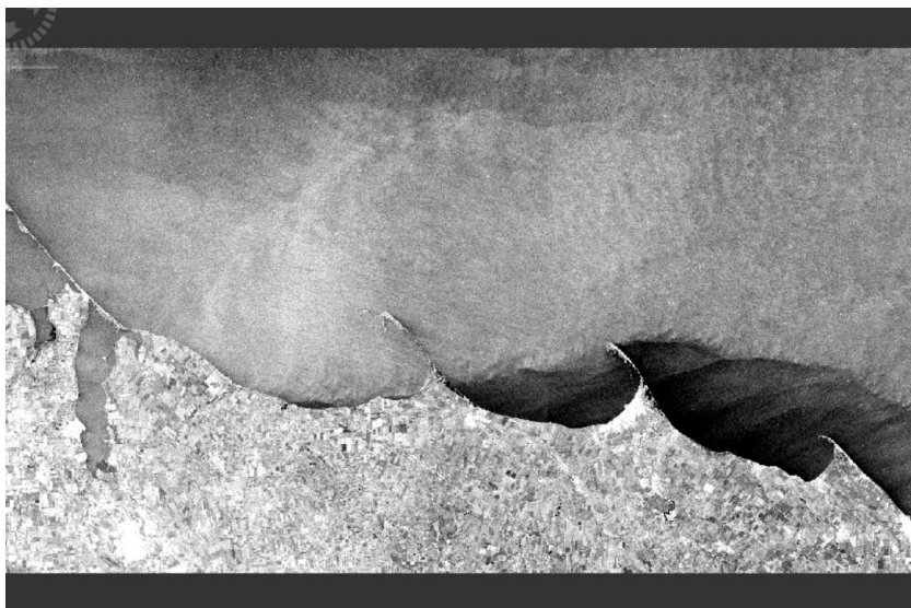
Рис. 3.14 Амплітудні дані Sentinel-1 для Азовського моря поблизу м. Бердянськ за 12 вересня 2022 року переведені в дБ і після фільтрації
