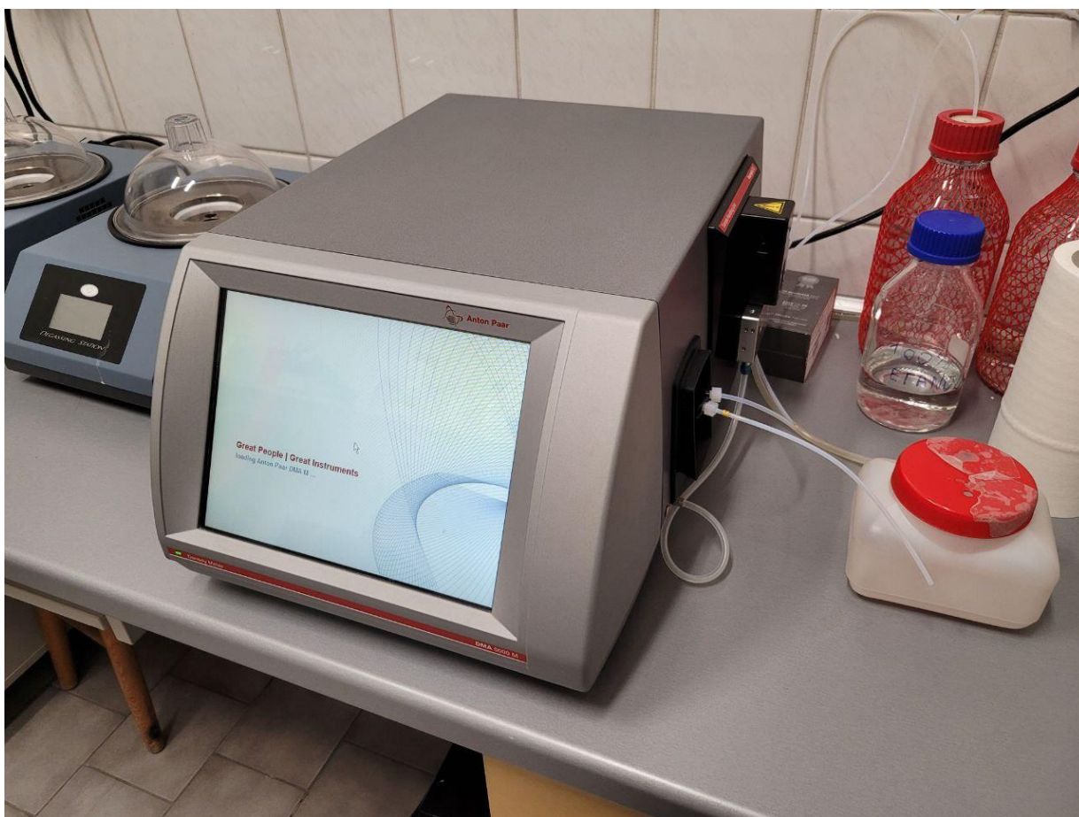
Рисунок 2.3 – Зображення високоточного густиноміра Anton Paar DMA 5000 M .
