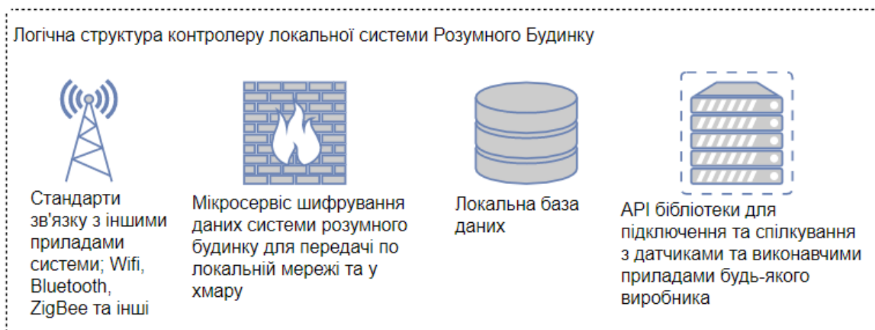
Рисунок 3.2. Логічна структура локального контролеру системи Розумного Будинку
