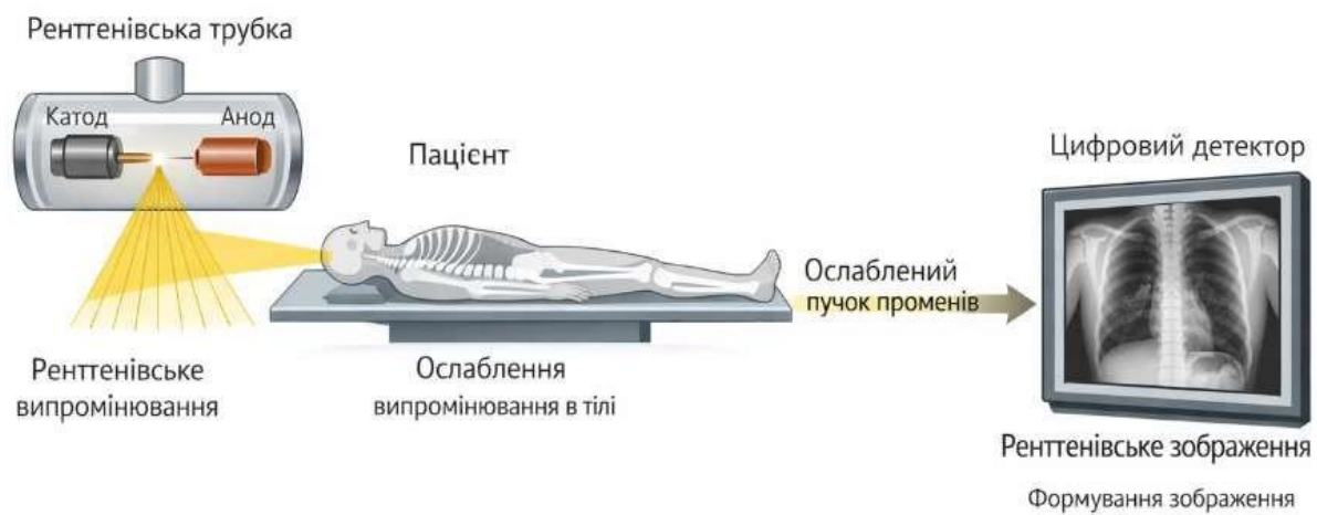
Рисунок 1.1 – Схема формування рентгенівського зображення
