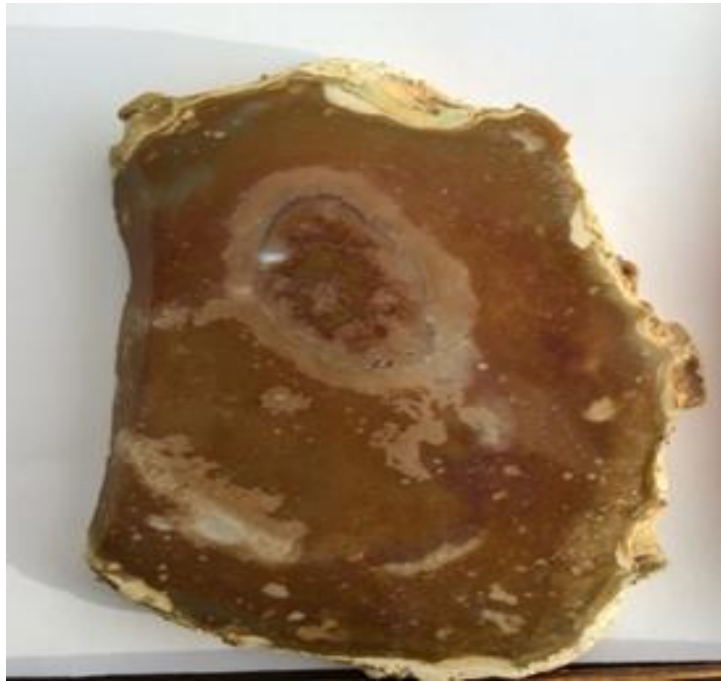
Рис. 4.12. Зразок кольорового кременю Волино-Подільської плити (Тернопільська обл.) зі змішаним текстурним забарвленням – плямистого та концентрично-зонального
