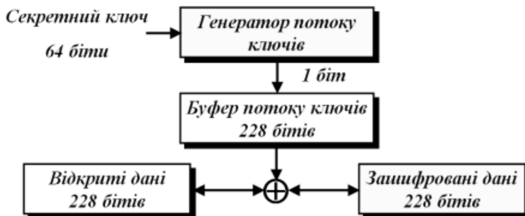
Рисунок 2.1 – Принцип побудови алгоритму A5/1
