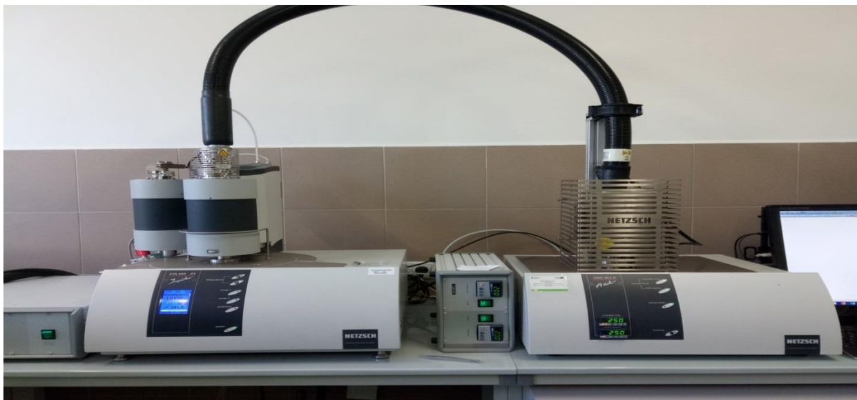
Фото 2.3. Калориметр “STA 449 Jupiter F1” з мас-спектроскопічною приставкою “QMS 403C Aëolos”
