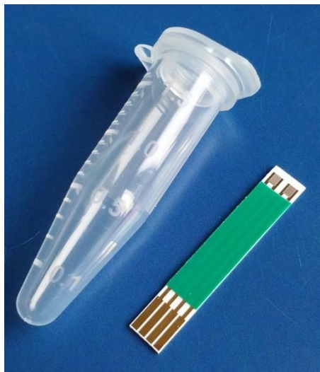
Рис. 2.1. Зовнішній вигляд кондуктометричного перетворювача на основі золотих гребінчастих електродів
