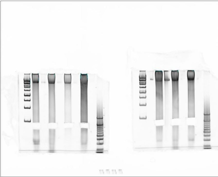
Рис. 2.3. Гель-електрофорез без фрагментів довжиною 200 пар.
