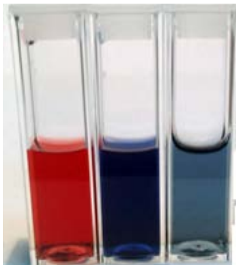
Рис. 1.1. Синтезовані колоїдні розчини наноструктур золота: зліва направо – суцільні наночастинки золота, нанооболонки золота та наноклітки золота [5].
