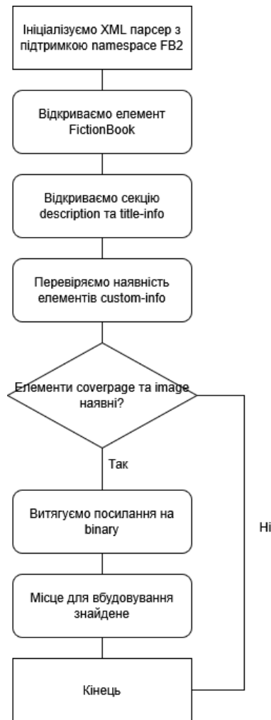
Рисунок 2.2 – Загальний вигляд алгоритму пошуку елемента <binary> який містить обкладинку
