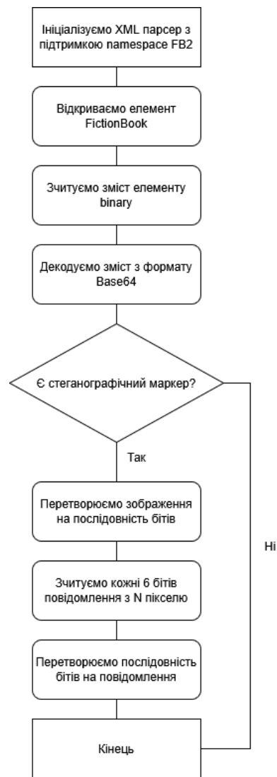
Рисунок 2.5. Блок–схема алгоритму витягування повідомлення з обкладинки
