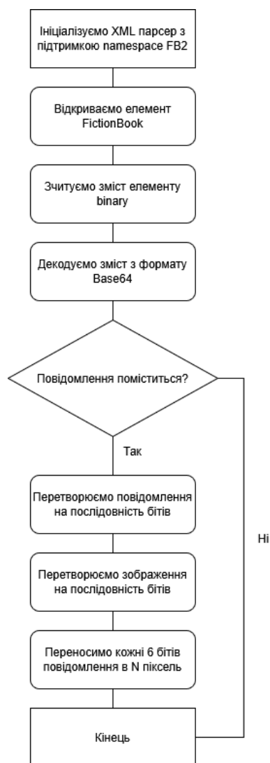
Рисунок 2.4 – Блок-схема алгоритму вбудовування повідомлення в обкладинку
