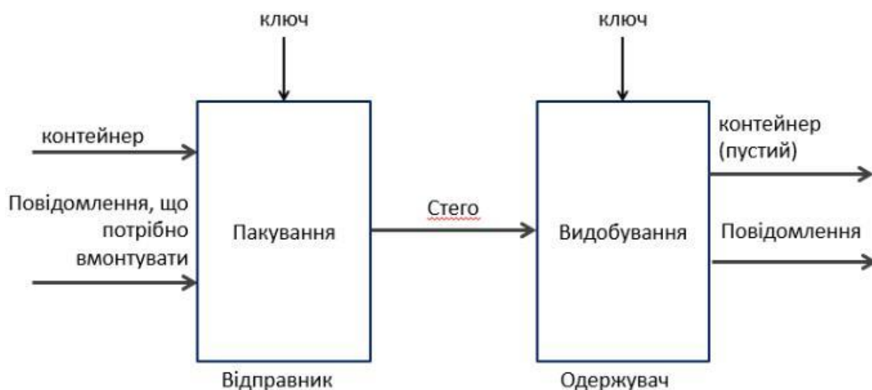
Рисунок 1.1 – Загальний приклад роботи стеганографічної системи
