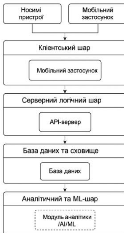
Рис. 2.1. Загальний вигляд архітектури системи
