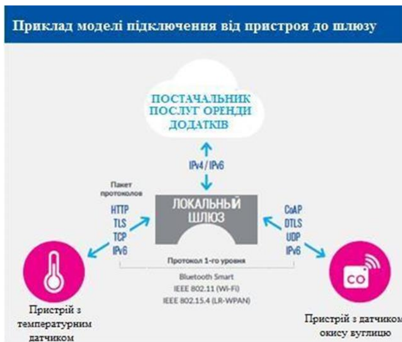
Рисунок 2.3 - Під'єднання від пристрою до шлюзу
