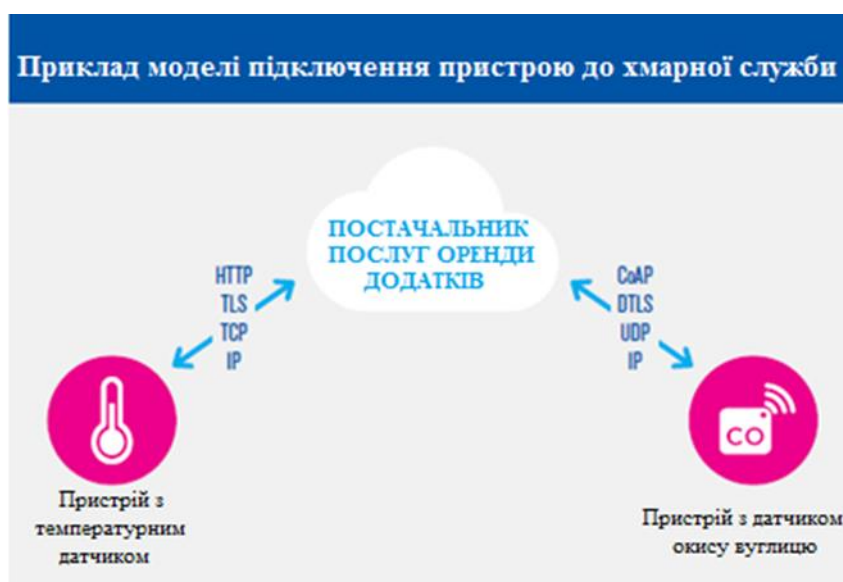
Рисунок 2.2 - Під'єднання від пристрою до хмари
