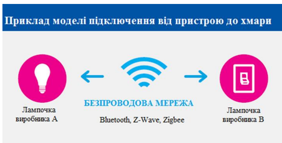
Рисунок 2.1 – Під'єднання від пристрою до пристрою
