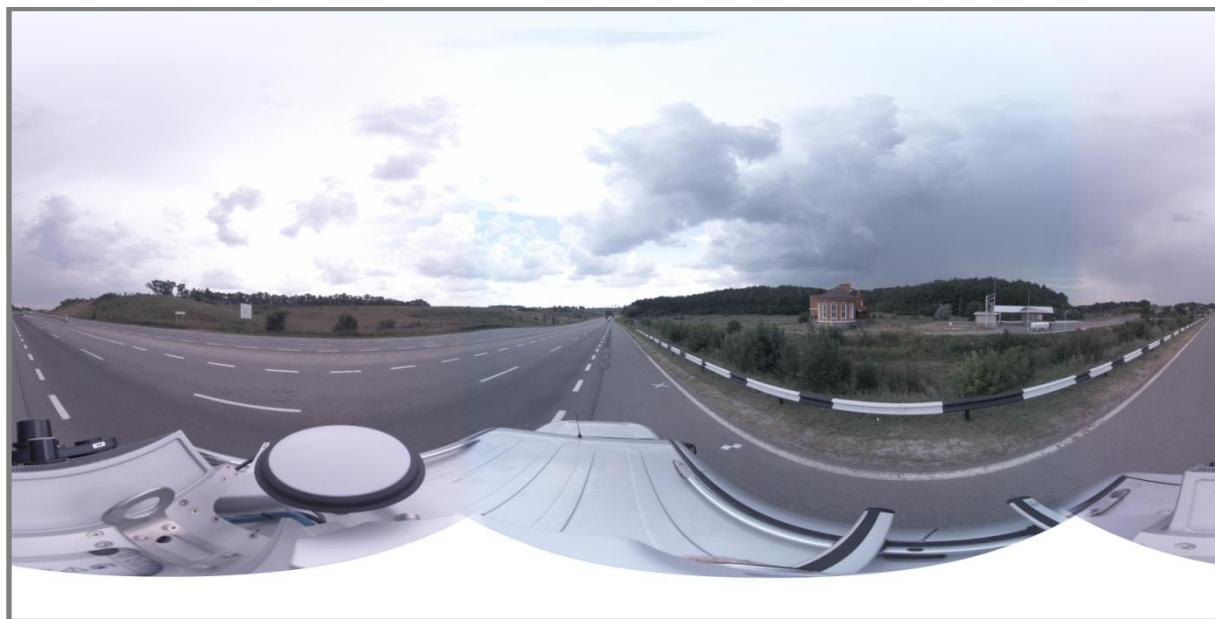
Рис. 7. Панорамний знімок кінцевої точки ділянки дороги з мітками біля узбіччя зроблений скануючою системою Leica Pegasus: Two
