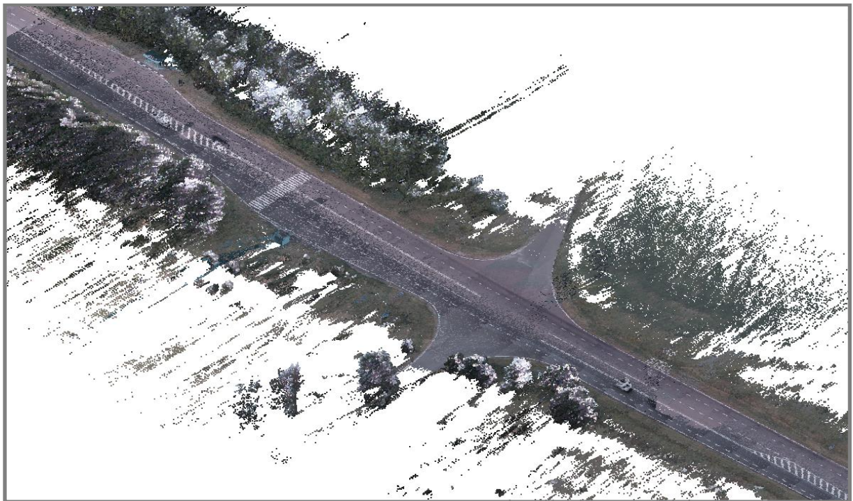
Рис. 6. Фрагмент «хмари» точок, отриманий при зйомці скануючою системою
