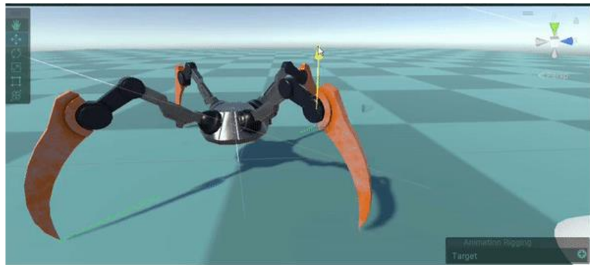
Рис 5.3 – Рух ноги павука за допомогою інверсної кінематики
