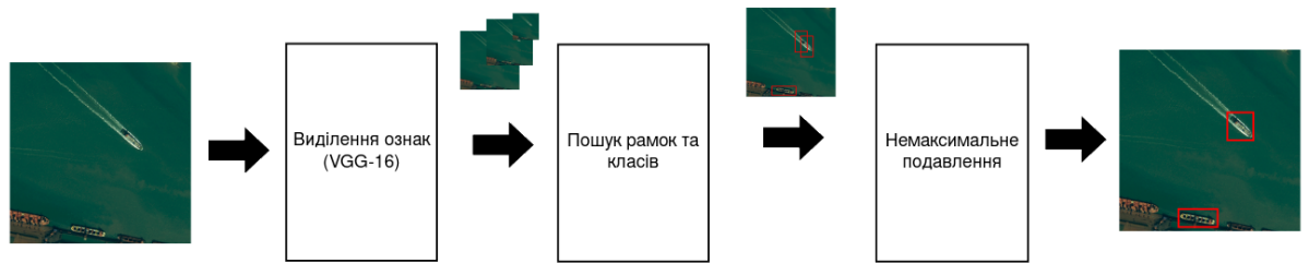
Рисунок 3.2 – Архітектура модулів моделі SSD
