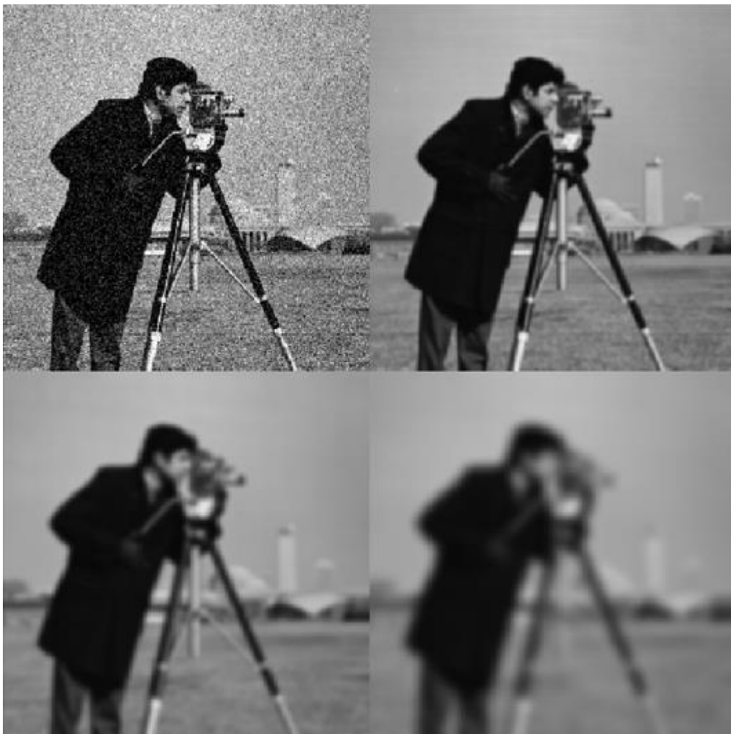
Малюнок 2. (а) Вхідне зображення під впливом деякого шуму; (б) Результат роботи фільтра Гауса з параметром \sigma = 1 ; (в) Результат роботи фільтра Гауса з параметром \sigma = 2 ; (г) Результат роботи фільтра Гауса з параметром \sigma = 4 .
