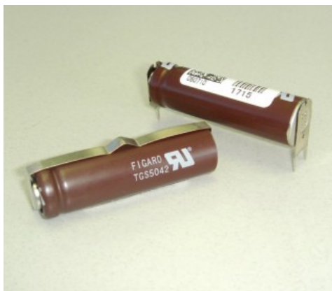
Рис. 2.15. Зовнішній вигляд датчика TGS5042.
