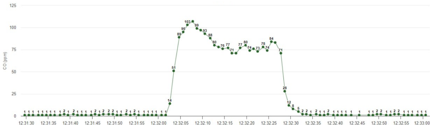
Рис. 3.6. Графік залежності відгуку датчика (в ppm) від часу вимірювання в атмосфері диму від сірника.
