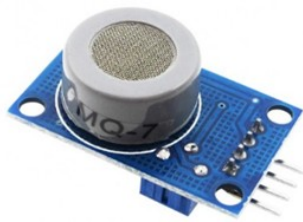
Рис. 2.5. Зовнішній вигляд датчика MQ-7 [6].
