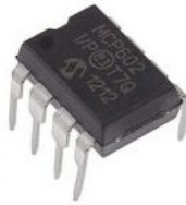
Рис. 2.16. Зовнішній вигляд операційного підсилювача MCP602.
