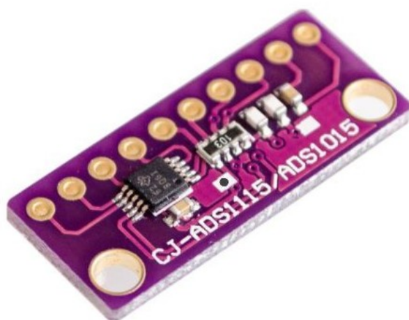
Рис. 2.10. Зовнішній вигляд плати аналого-цифрового перетворювача на мікросхемі ADS1115 [9].
