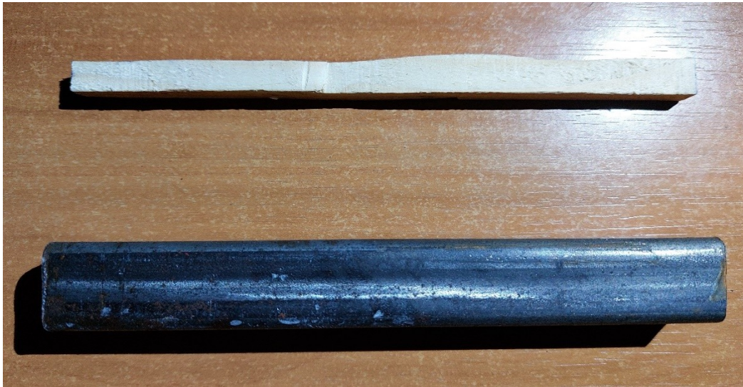
Рис. 5.5. Брусок та профільна труба, які було використано для побудови датчика.
