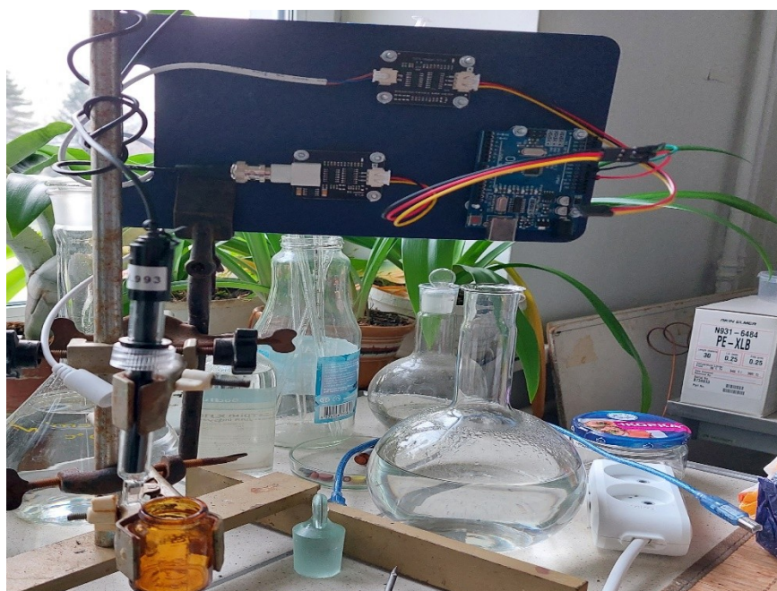
Рис. 6.6. Загальний вигляд установки для вимірювання електропровідності розчину із використанням датчика EC Meter V1.0.
