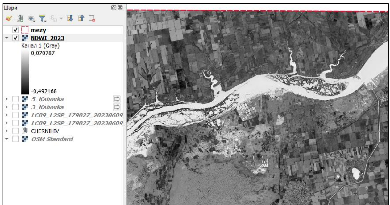
Рис. 3.22. Скріншот отриманого монохромного обчисленого растру NDWI
